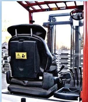
I gruppi di sollevamento, con profilo da 2 ton, progettati e realizzati interamente da Montini, con profilo a "C", sono piallati e rettificati a mano, uno ad uno, per ottenere massima scorrevolezza, maggiore stabilità e sicurezza nelle grandi alzate.
