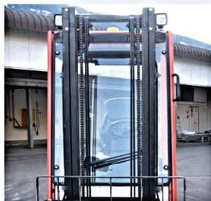
Realizzato con speciali profili, il tetto è progettato per essere cabinato in qualsiasi momento, senza dover modificare o sostituire la struttura originale.
