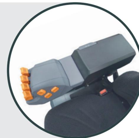
Il **comando idraulico con leve pilot** (mini-joystick) permette di guidare il carrello in modo semplice ed affidabile. Agilmente accessibile e facile nel suo uso, è installato in un bracciolo ergonomico, regolabile con comando direzionale, per garantire comode posizioni di guida.
