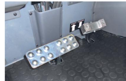
Optional, Pedalsteuerung mit Einzelpedal und zentralem Bremspedal (mit Richtungsschalter am Lenkrad oder am Joystick).
