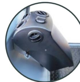
Das als Option erhältliche **Heizgerät** sorgt durch mehrere Lüftungsdüsen für das direkte und schnelle Heizen der Fahrkabine.
