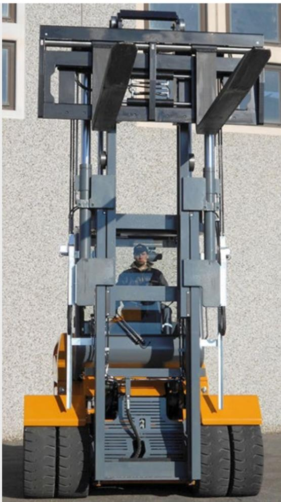
Zur Verbesserung der Sicht, des Komforts und der Sicherheit des Fahrers ist die **Fahrkabine** als Option **in voll verglaster Ausführung** entwickelt worden. Damit wird dank der breiten Frontscheibe, die über die große Dachscheibe hinweg von der vorderen Seite bis ganz nach hinten reicht, freie Rundumsicht garantiert.
