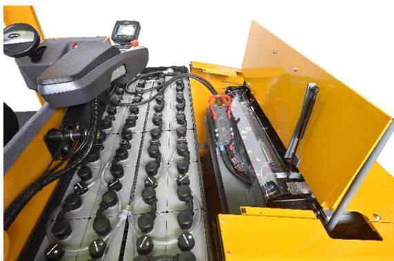
**Batteria a 48V a grande autonomia**
