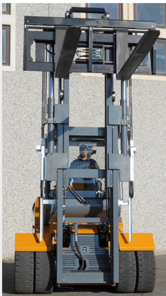
Nell'ottica di migliorare la visibilità, il confort e la sicurezza del carrellista, la **cabina di guida** è stata **studiata a tutto vetro**, in opzione, **per garantire una visuale totale**, grazie al largo parabrezza che si estende dalla parte anteriore fino a quella posteriore, passando dall'ampio vetro sopra il tetto.
