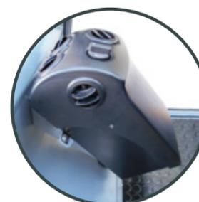
Il **riscaldatore**, disponibile in opzione, permette, tramite più bocchette d'aria, il riscaldamento diretto e veloce dell'interno della cabina.
