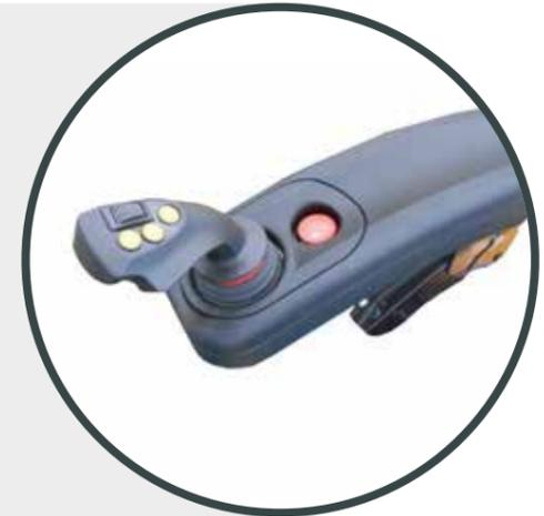
Die bedienungsfreundliche und leicht zugängliche **Fingertips-Hydrauliksteuerung** (Mini-Hebel) ist in eine ergonomische, verstellbare Armlehne eingebaut. Einfach nur die Fingertips-Steuerungen sanft betätigen, und schon kann der Gabelstapler flink, präzise und sicher gelenkt werden.
