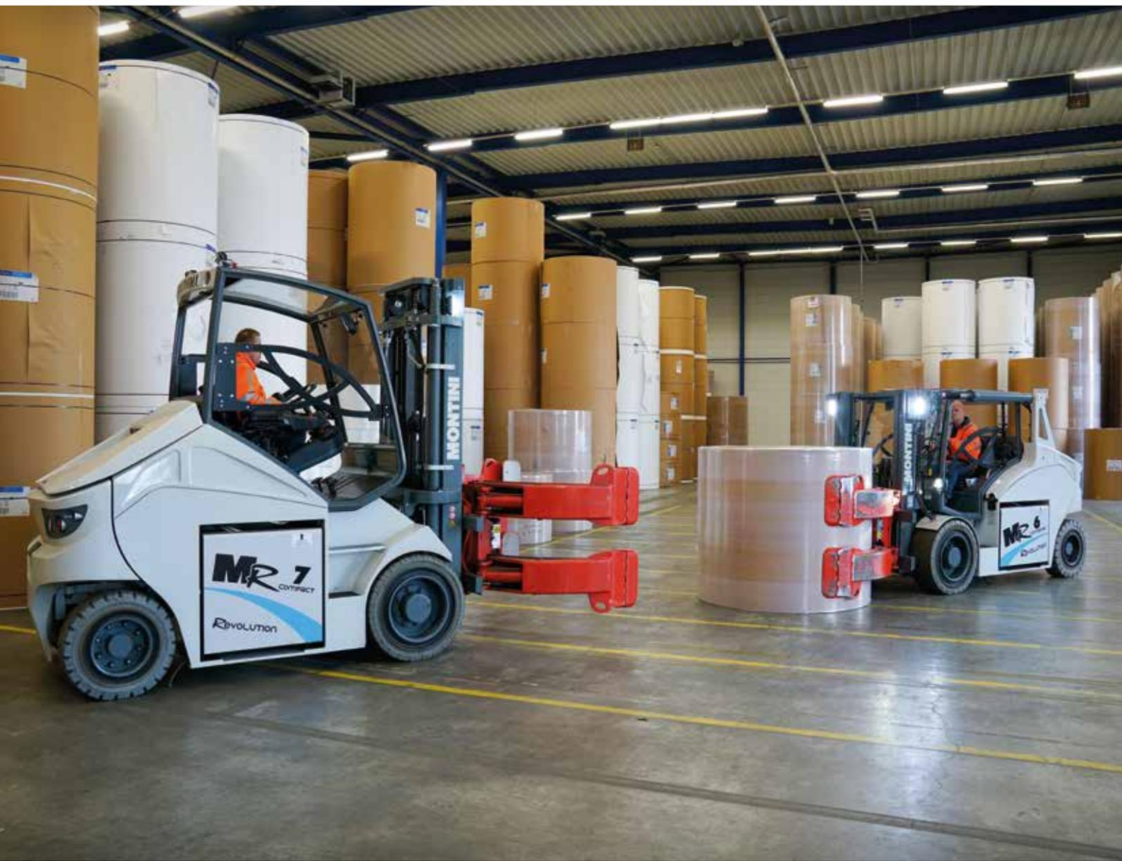
DIE NEUEN GABELSTAPLER 96V MIT TRAGFÄHIGKEITEN VON 6000 UND 7000 KG
