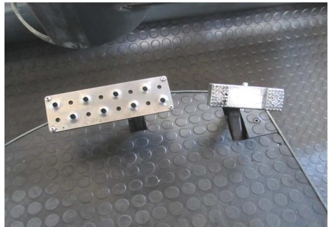
Opzionale, per il confort e l'efficienza degli operatori, è previsto un gruppo pedaliera con doppio pedale e freno centrale.
