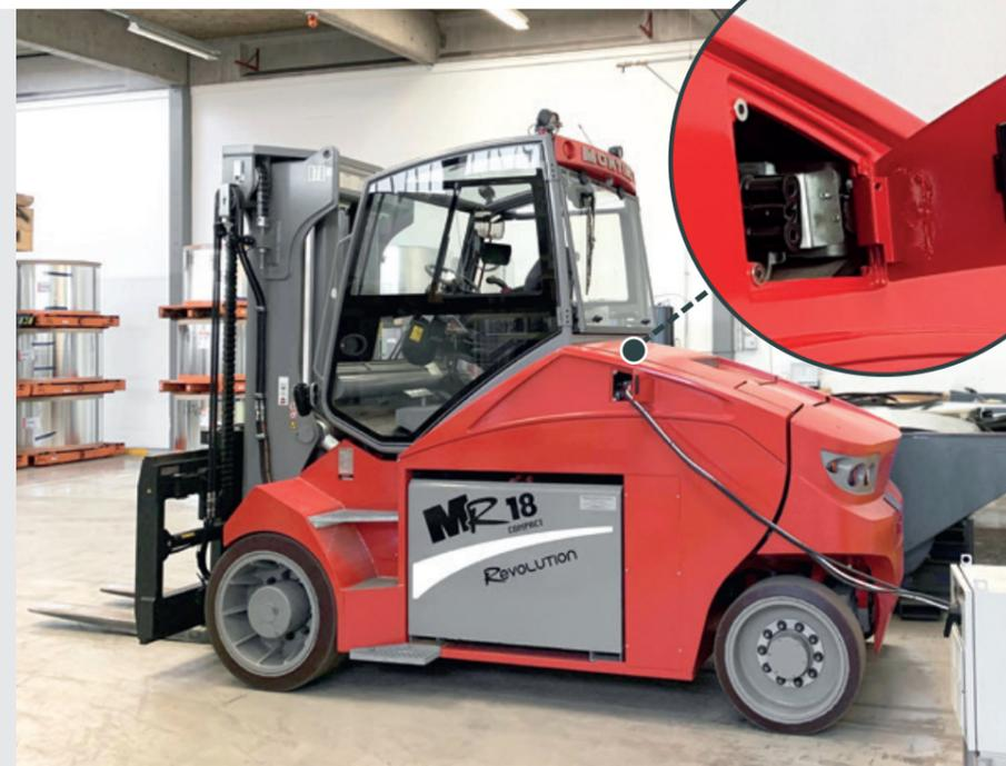
La **ricarica della batteria** avviene in **modalità diretta**, per mezzo del connettore collocato in comoda posizione e chiuso da un pratico sportellino, come nelle autovetture elettriche.
