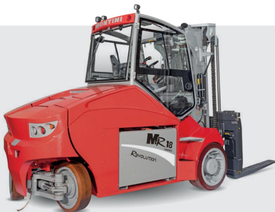
Ogni aspetto tecnico è stato progettato per agevolare la guida del carrello in ogni situazione lavorativa: dalla **particolare forma spiovente del contrappeso**, che garantisce una perfetta visibilità in retromarcia, fino alla **grande maniglia di salita**, per accedere facilmente alla postazione di guida.
