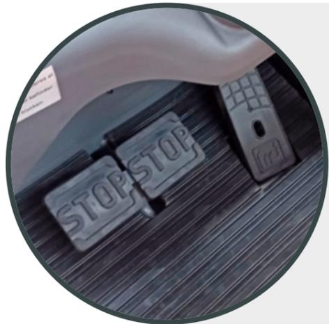
Breite und geräumige Pedalsteuerung mit **Einzelpedal** (mit Vorwärts-/Rückwärtsschalter in der Armlehne der Hydrauliksteuerung) und großem Bremspedal.
