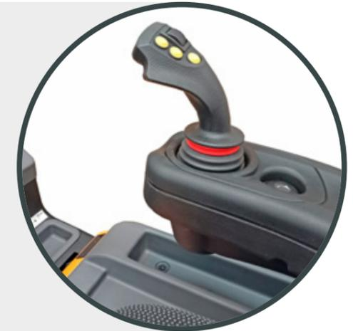
Mit der intuitiven und ergonomischen **Joystick-Hydrauliksteuerung** können alle hydraulischen Funktionen des Staplers mit nur einem Steuerhebel bedient werden. Maximale Produktivität, dank der Anwendung von zwei gleichzeitig mit dem Hubgestüt ausgeführten Arbeitsfunktionen.
