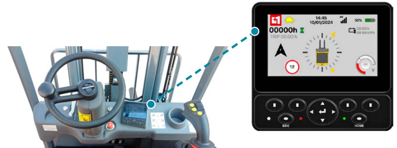
Das Display, das **dank des Umgebungslichtsensors für die automatische Anpassung der Bildschirmhelligkeit und die Definition des Tag- oder Nachtmodus leicht ablesbar ist**, ermöglicht den Zugriff über die Startseite der wichtigsten Informationen:
