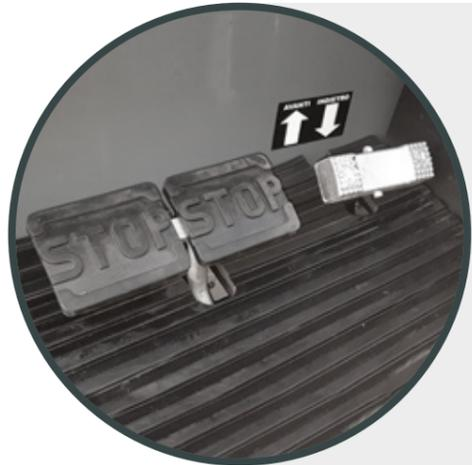
Pedalsteuerung mit **Kippedal für Vorwärts-/Rückwärtsfahrt** und breitem und bequemem Bremspedal, das eine sichere Grifffläche am Bremspedal für Sicherheit und Komfort bietet.
