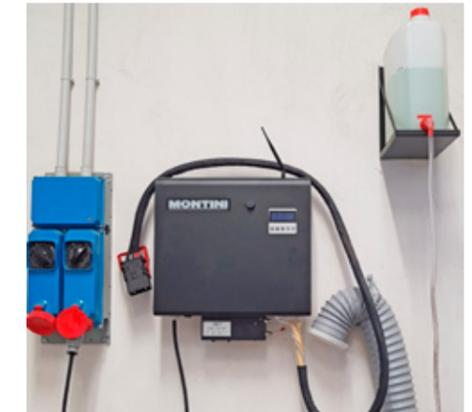
Das intelligente MONTINI Ladegerät passt die Stromstärke automatisch an die Batteriekapazität an und merkt sich, wenn der Elektrolyt nachgefüllt werden muss.
