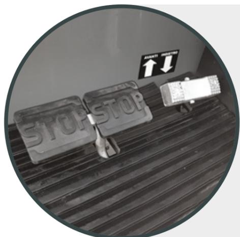
Gruppo pedaliera con **pedale di marcia avanti e indietro a bilanciere** e con largo e comodo pedale freno, in modo d'avere una superficie di presa sicura al pedale del freno, per sicurezza e confort.
