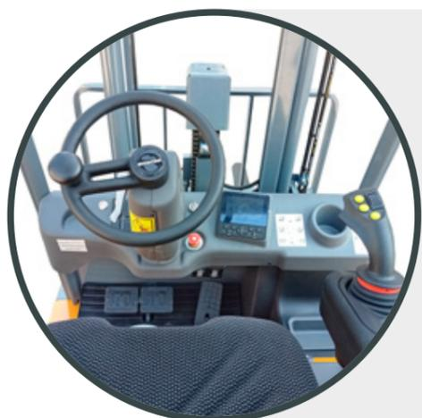
L'**abitacolo di guida** è spazioso, dotato di un'ampia pedana e di un sedile molto confortevole. La **plancia operatore** è fornita di display multifunzione; volante regolabile in altezza e inclinazione e di ridotte dimensioni per favorire la massima manovrabilità.
