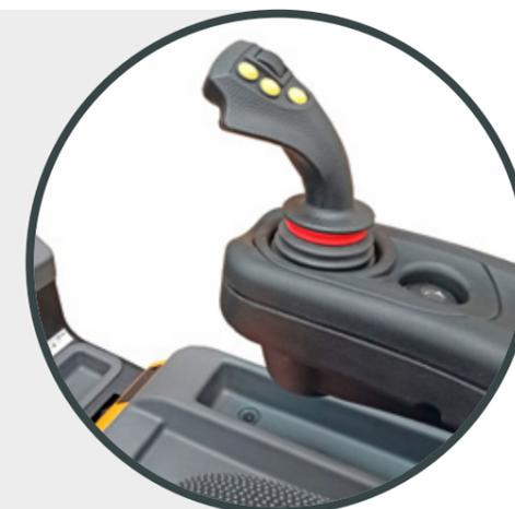
L'intuitivo ed ergonomico **comando idraulico a joystick** permette di esercitare, con un'unica leva di comando, tutte le funzioni idrauliche del carrello. Massima produttività, grazie all'utilizzo di due funzioni operative e contemporanee al gruppo di sollevamento.
