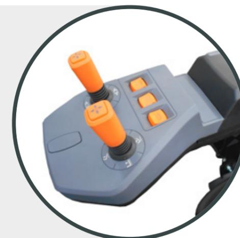
Il **comando idraulico con leve pilot** (mini-joystick) permette di guidare il carrello in modo semplice e affidabile. Agilmente accessibile e facile nel suo uso, è installato in un bracciolo ergonomico, regolabile con comando direzionale, per garantire confortevoli posizioni di guida.
