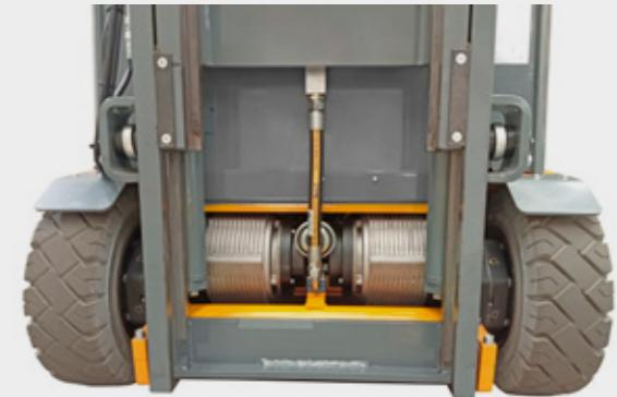
Motori con **riduttori integrati senza freni idraulici** per avere:
