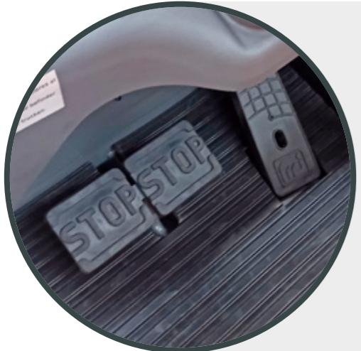
Ampio e spazioso gruppo pedaliera con **mono-pedale** (con invertitore di marcia avanti e indietro tramite pulsante al braccio del comando idraulico fornito) accompagnato da un grande pedale freno.
