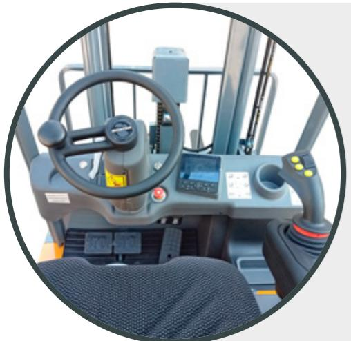
L'**abitacolo di guida** è spazioso, dotato di un'ampia pedana e di un sedile molto confortevole. La **plancia operatore** è fornita di display multifunzione; volante regolabile in altezza e inclinazione e di ridotte dimensioni per favorire la massima manovrabilità.
