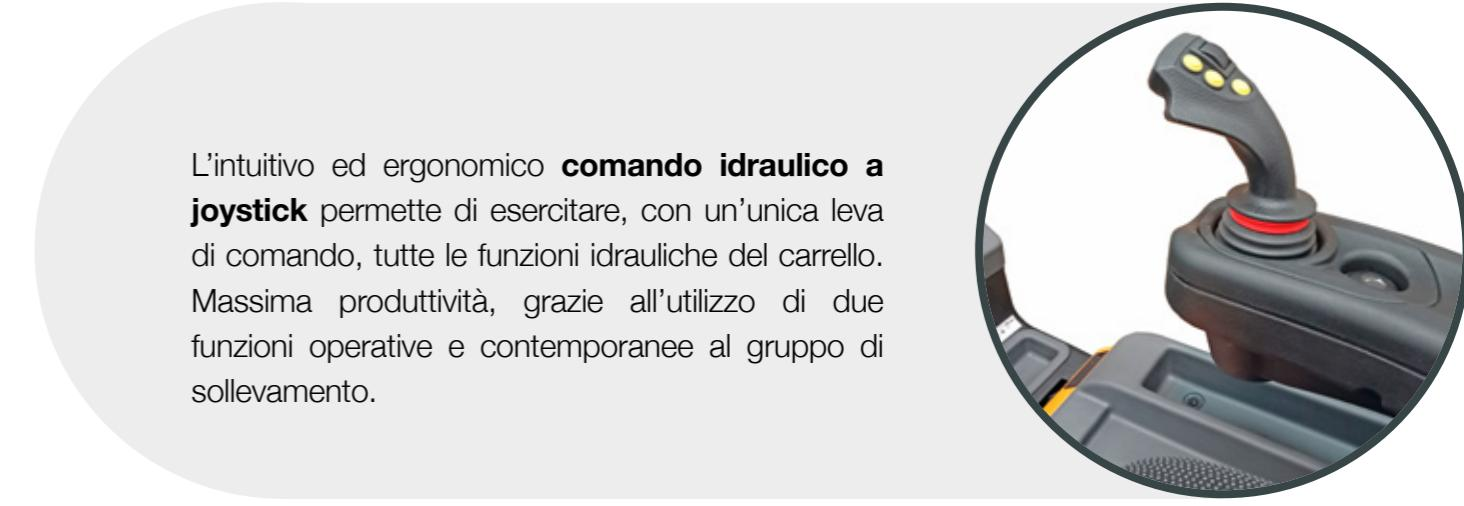
L'intuitivo ed ergonomico **comando idraulico a joystick** permette di esercitare, con un'unica leva di comando, tutte le funzioni idrauliche del carrello. Massima produttività, grazie all'utilizzo di due funzioni operative e contemporanee al gruppo di sollevamento.
