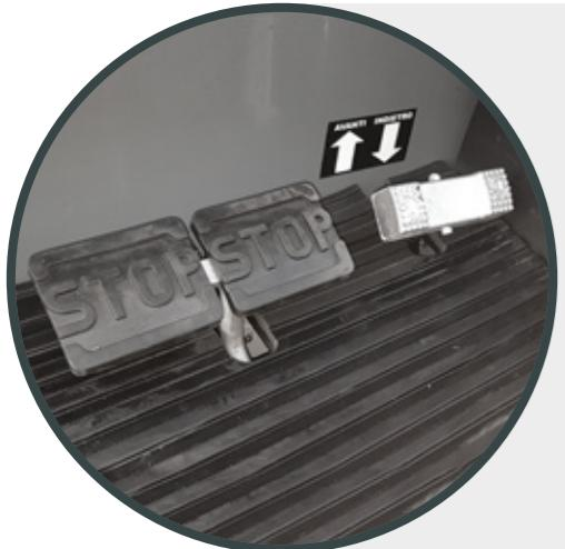
Gruppo pedaliera con **pedale di marcia avanti e indietro a bilanciere** e con largo e comodo pedale freno, in modo d'avere una superficie di presa sicura al pedale del freno, per sicurezza e confort.
