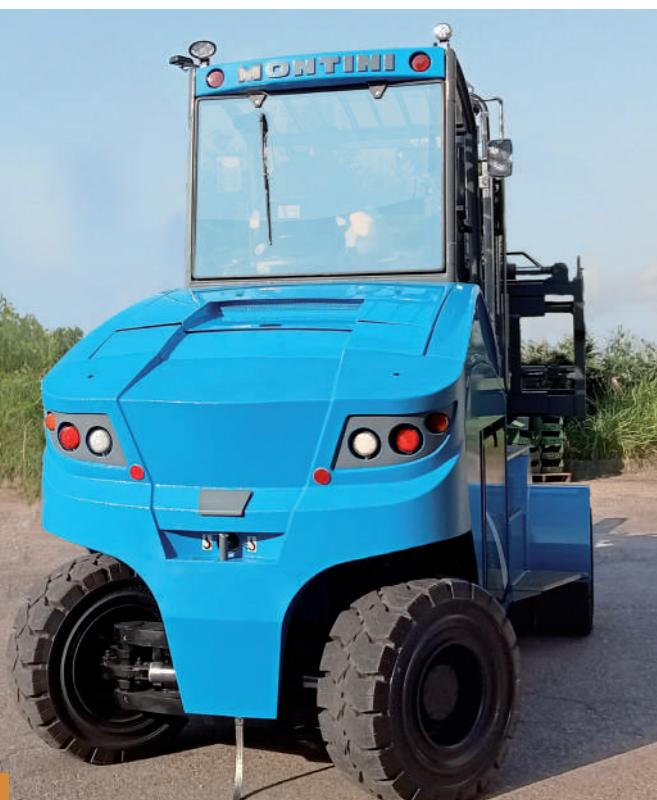
Ogni aspetto tecnico è stato progettato per agevolare la guida del carrello in ogni situazione lavorativa: dalla **particolare forma spiovente del contrappeso**, che garantisce una perfetta visibilità in retromarcia, fino alla **grande maniglia di salita**, per accedere facilmente alla postazione di guida.
