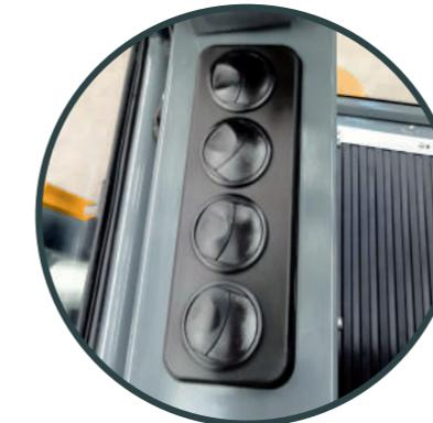
**Il riscaldatore**, disponibile in opzione, permette, tramite più bocchette d'aria, il riscaldamento diretto e veloce dell'interno della cabina, garantendo la temperatura dell'abitacolo sempre confortevole.
