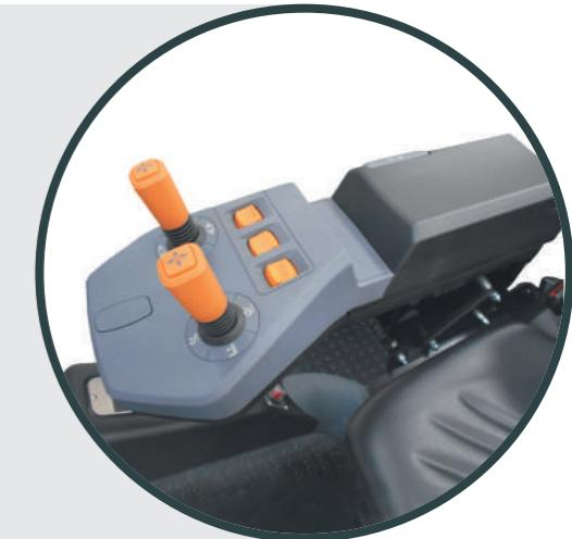
Il **comando idraulico con leve pilot** (mini-joystick) permette di guidare il carrello in modo semplice ed affidabile. Agilmente accessibile e facile nel suo uso, è installato in un bracciolo ergonomico, regolabile con comando direzionale, per garantire comode posizioni di guida.
