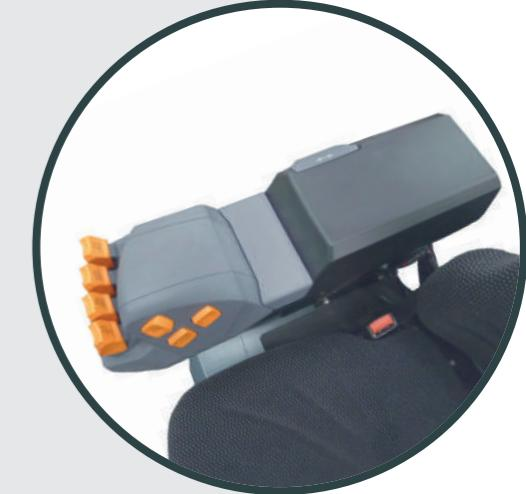
Il **comando idraulico con fingertips** (mini-leve), semplice nel suo utilizzo e facilmente accessibile, è installato in un bracciolo ergonomico, regolabile con comando direzionale. È sufficiente manovrare delicatamente il comando con fingertip per disporre di una guida e di una maneggevolezza agili, precise e sicure.
