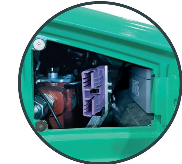
La **ricarica della batteria** avviene in modalità **diretta**, per mezzo del connettore collocato in comoda posizione, e chiuso da un pratico sportellino, come nelle autovetture elettriche.
